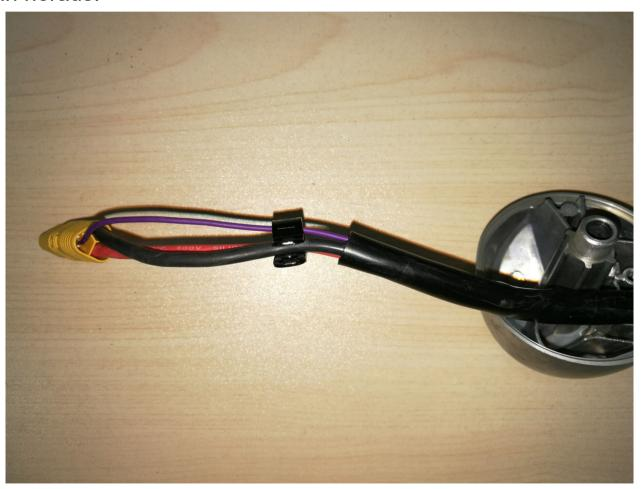
8. Ziehen Sie die Kabel aus dem Verbindungshebel heraus und ersetzen Sie den Verbindungshebel durch einen neuen.
