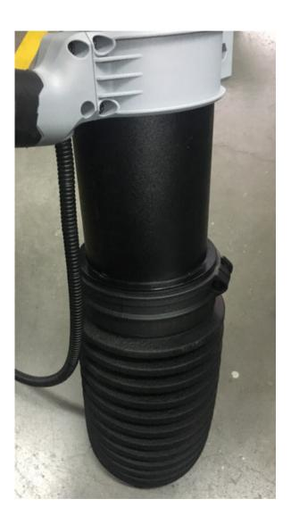
10. Schrauben Sie die Schelle mit der Schraube fest.
