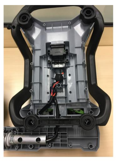
13. Bauen Sie das hintere Gehäuse mit dem vorderen Gehäuse mithilfe von Schrauben fest.
