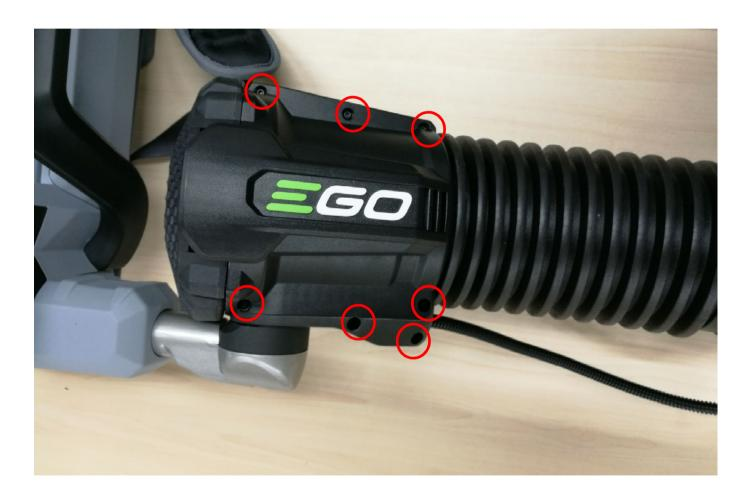
1. Bauen Sie das Gehäuse ab, wie in "So wird der Laubbläser auseinandergenommen" beschrieben und trennen Sie den Stecker 2, um die Handgriffbaugruppe von der Luftkanalbaugruppe zu trennen.
