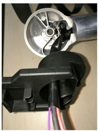
3. Lösen Sie die 8 Schrauben, um den Kabelbaum vom hinteren Gehäuse abzubauen.
