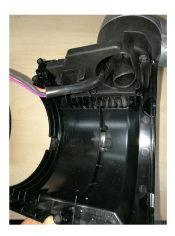
5. Richten Sie den Positionierblock an der Luftkanalbaugruppe mit der Nut an der Halterung aus, um die Luftkanalbaugruppe einzusetzen. Stecken Sie anschließend die Stecker 1, 2 und 3 ein.
