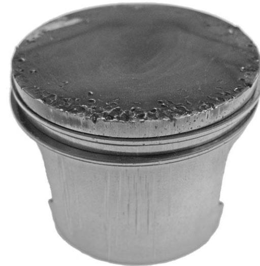
**Beschädigter oder fehlender Luftfilter:** der Kolbenkopf weist Spuren von Kleinteilen auf, im Kolbenhemd sind Schleifspuren zu erkennen
