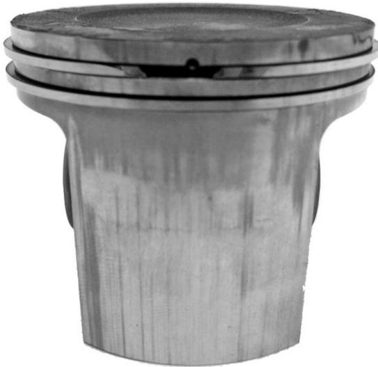
**Verschlissener Luftfilter:** das Kolbenhemd ist verschlissen (dünn) es sind keine Bearbeitungsspuren mehr erkennbar.
