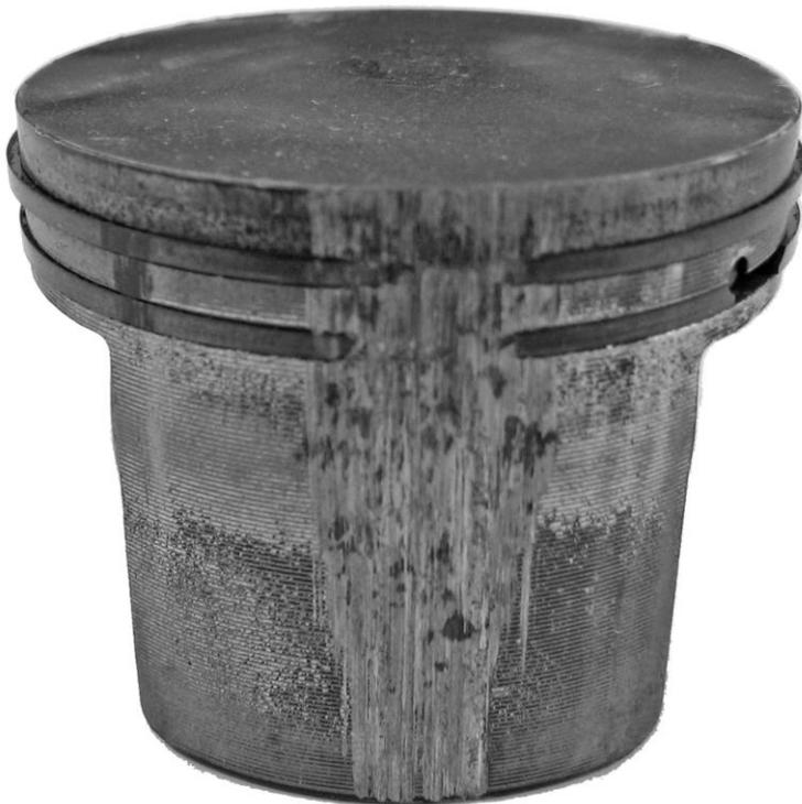
Charakteristisch für Überhitzungsschäden sind Fresser im Ring- und oberen Schaftbereich. Durch die übermäßige Erwärmung und die damit bedingte Durchmesservergrößerung kann es zum Klemmen im oberen Kolbenbereich der Auslassseite kommen.
