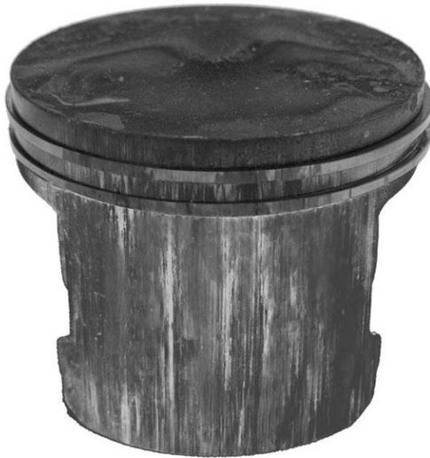
Intensive Oelkohleablagerung auf dem Kolbendach. Die Ringe setzen sich durch die Oelkohleablagerungen fest. Öl brennt sich in den Riefen des Kolbenhemdes fest.
