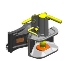
**Zugmäuler | Standard | Art. Nr. 05 2953.321** selbsttätige Bolzenkupplung (38mm Bolzen, A11) CH-I, DIN ähnlich 11028, ISO ähnlich 6489-2 | System JSV-Scharmüller (Halbmond) (295/25/26)
