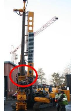
**Bohrgerät** Wechseln Bohrkronen
