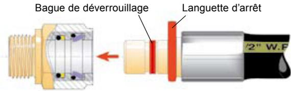
2. L'introduction du raccord mâle dans le raccord femelle provoque l'ouverture des segments de verrouillage.
