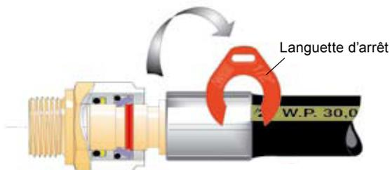
1. Retirez la languette d'arrêt à l'aide d'un tournevis.
