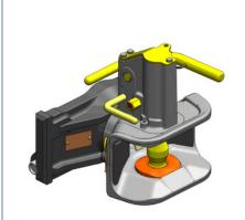
**Zugmäuler | Standard | Art. Nr. 05 2953.021** selbsttätige Bolzenkupplung (38mm Bolzen, A11) CH-I, DIN ähnlich 11028, ISO ähnlich 6489-2 | System JSV-Scharmüller (Halbmond) (295/25/26)
